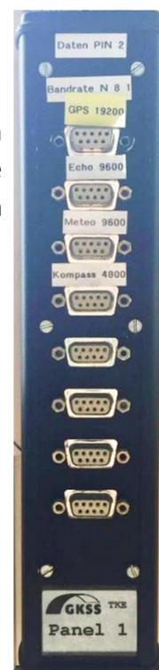
Abb. 13: Steckerleiste im Messraum der Prandtl
