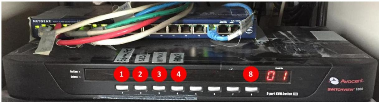
Abb. 12: VGA Switch im Echolot Rack zur Bildweiterleitung an den Schiffsführer
