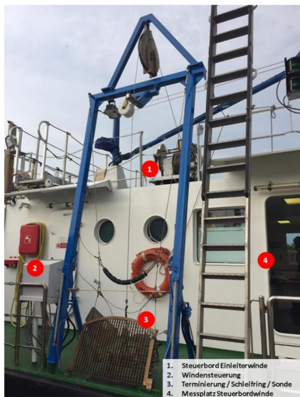
Abb. 15: Steuerbordwinde und zugehörige Komponenten
